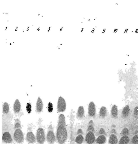
Obr. 3. Chromatogram 0149/88 bol trikrát vyvíjaný zmesou n -butanol — voda (1 : 1) a detegovaný postriekanim Dragendorfovým činidlom.
