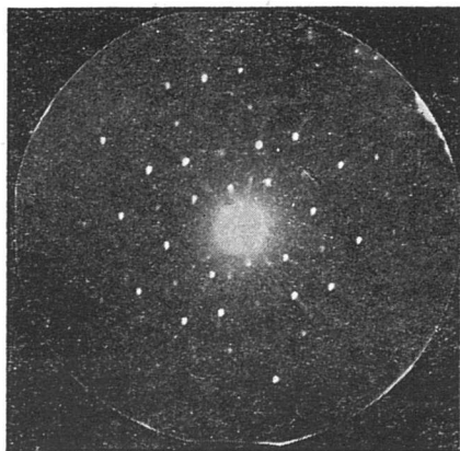
Obr. 6a. Precesná snímka artabsínu kryštalovaného zo zmesi benzénu a petroléteru. Recipročná rovina (h0l) , \bar{\mu} = 20^\circ , \text{CuK}_\alpha , exp. 2 hod., 20 kV, 12 mA.
