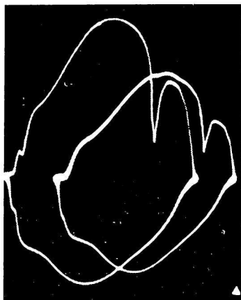
Oscilogram 1. Jervín a pseudojervín v 1 N-LiOH; koncentrácia 5 \cdot 10^{-5} M; kvapková elektróda; 0,2 mA.
