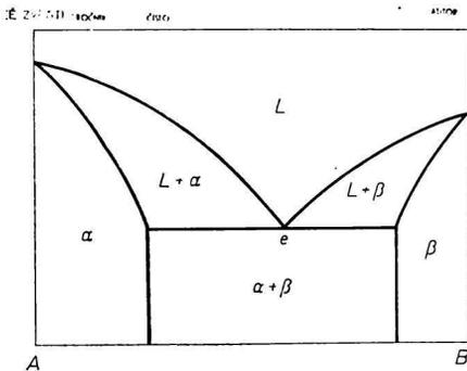
Abb. 1. Phasendiagramm des binären Systems A—B mit Eutektikum und mit begrenzten festen Lösungen auf Basis beider seiner Komponenten.
