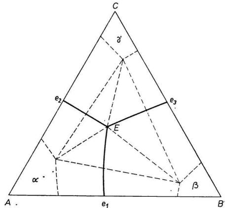
Abb. 2. Konzentrationsdreieck des ternären Systems A—B—C mit Eutektikum und mit begrenzten festen Lösungen auf Basis aller drei Komponenten.
