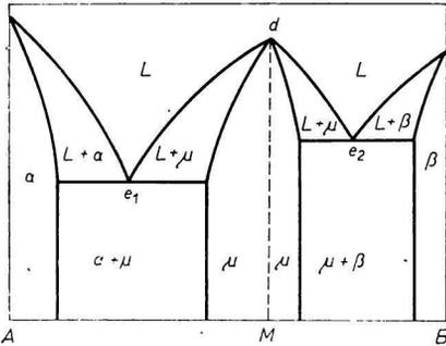
Abb. 3. Das binäre System A—B mit der kongruent schmelzenden chemischen Verbindung M und mit begrenzten festen Lösungen auf Basis aller drei Bestandteile.
