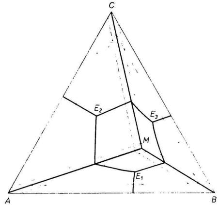
Abb. 4. Konzentrationsdreieck des ternären Systems A—B—C mit einer kongruent schmelzenden ternären Verbindung und mit begrenzten festen Lösungen auf Basis aller vier Bestandteile.
